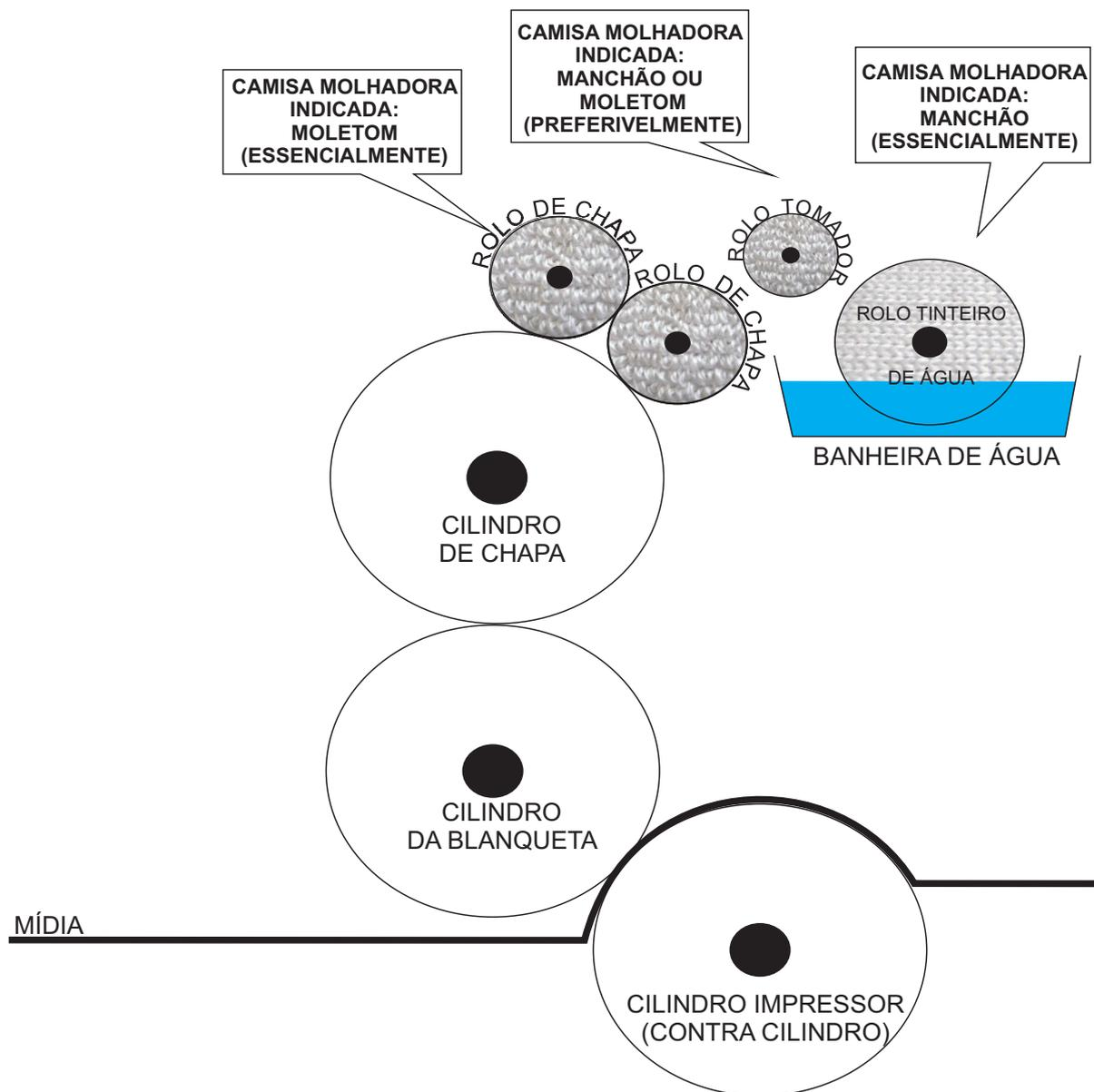
AS MÁQUINAS ROTATIVAS TEM, GERALMENTE, A REGULAGEM DO SISTEMA DE ÁGUA, FEITA AUTOMATICAMENTE. ATRAVÉS DE MOTOR INDIVIDUAL DO CILINDRO TINTEIRO DE ÁGUA. QUANTO MAIOR A VELOCIDADE DE GIRO DO CILINDRO, MAIOR A QUANTIDADE DE ÁGUA TRANSPORTADA. SE A REGULAGEM FOR FEITA MECANICAMENTE, ATRAVÉS DA ADEQUAÇÃO DOS «DENTES DE ÁGUA» DO CILINDRO TINTEIRO DE ÁGUA. QUANTO MAIS «DENTES» ENGATADOS MAIOR A VELOCIDADE DE GIRO DO CILINDRO, E MAIOR A QUANTIDADE DE ÁGUA TRANSPORTADA.
