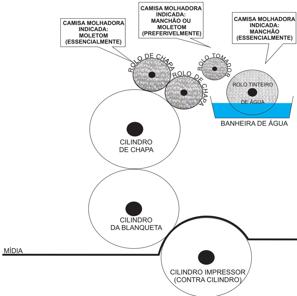
AS MÁQUINAS ROTATIVAS TEM, GERALMENTE, A REGULAGEM DO SISTEMA DE ÁGUA, FEITA AUTOMATICAMENTE. ATRAVÉS DE MOTOR INDIVIDUAL DO ROLO TINTEIRO DE ÁGUA. QUANTO MAIOR A VELOCIDADE DE GIRO DO ROLO, MAIOR A QUANTIDADE DE ÁGUA TRANSPORTADA. SE A REGULAGEM FOR FEITA MECANICAMENTE, ATRAVÉS DA ADEQUAÇÃO DOS «DENTES DE ÁGUA» DO ROLO TINTEIRO DE ÁGUA. QUANTO MAIS «DENTES» ENGATADOS MAIOR O GIRO DO ROLO, LOGO, MAIOR A QUANTIDADE DE ÁGUA TRANSPORTADA.
